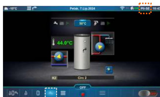
Zaslon potrošne tople vode (PTV) (PII-SE)
