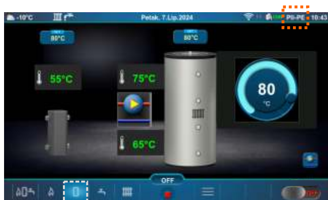
Zaslon akumulacijskog spremnika (PII-PE)
