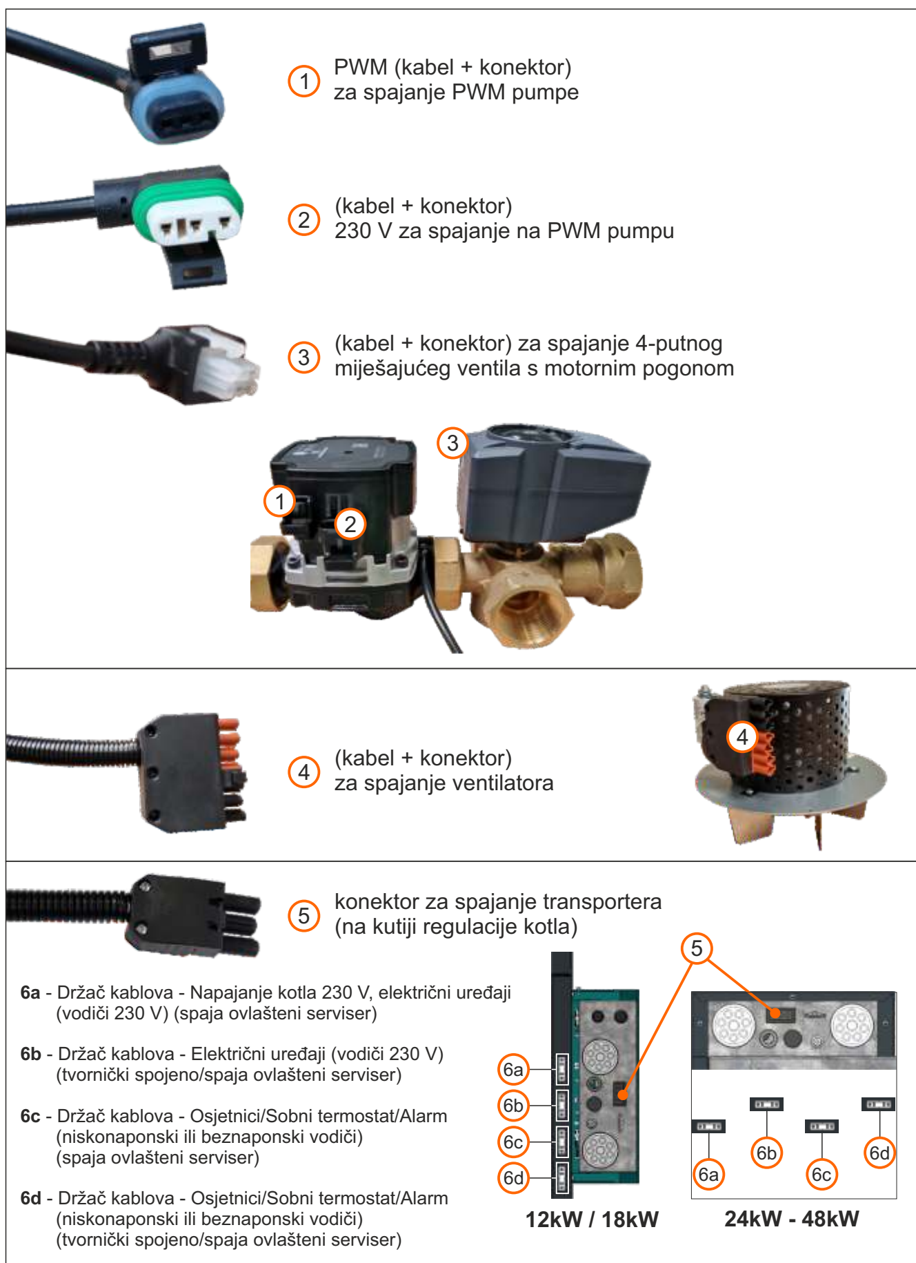
Slika 5. Konektori / kablovi s konektorima koji se moraju spojiti tijekom montaže kotla.
