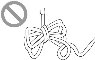
U protivnom postoji opasnost od ozljeda osoba uslijed strujnog udara ili požara.
