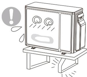
U slučaju oštećenja postolja može doći do pada i oštećenja jedinice.
