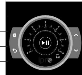
Ponavljanje progresivno svijetljenje indikatora tlaka između nule i postavljenog tlaka: pumpa radi.
