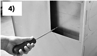
4) odvijačem skinite unutarnji zaštitni poklopac
