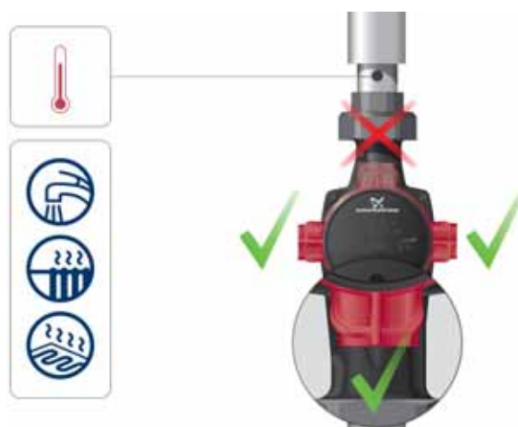
Slika 3 Položaji upravljačke kutije, sustava grijanja i sustava kućne potrošne tople vode
