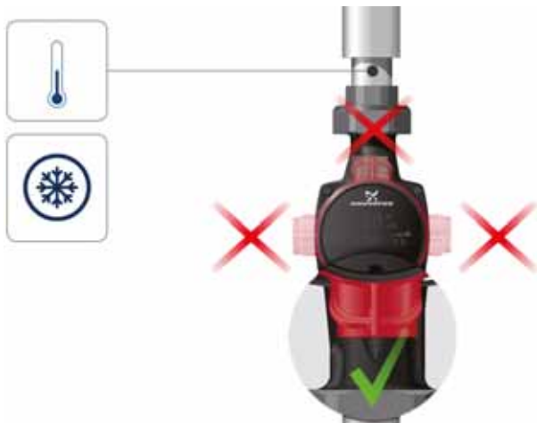
Slika 4 Položaj upravljačke kutije, klimatizacija i sustavi s hladnom vodom
