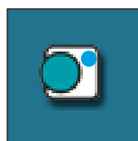
Na simbolu sobnog termostata treperi plavi krug (sobni termostat je dao zahtjev za radom pumpe, pumpa ne radi ako nisu ispunjeni svi uvjeti za njezin rad; npr. preniska temp. u kotlu, inače radi)
