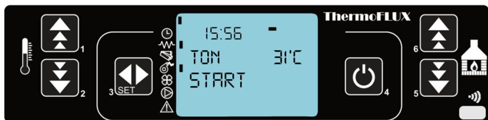
Na displeju će biti ispisano **START**, sa lijeve strane vidimo da su aktivirani grijač i usisni ventilator. Oznaka **tON** nam govori da je spojen sobni termostat ili je postavljen spojni mostić na izlazu predviđenom za sobni termostat (tvornički ugrađeno)
