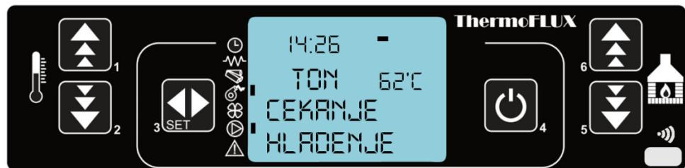
Kada temperatura u kotlu opadne na 3°C ispod zadane vrijednosti regulacija će automatski pokrenuti proces potpaljivanja.
