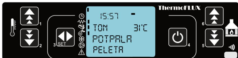
Nakon što se pelet upali , i temperatura dimnih plinova poraste na vrijednost od 55°C regulacija je dobila signal da je vatra prisutna i kotao nastavlja da radi po zadanim vrijednostima.
