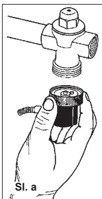
Instalacija ispusnog ventila za termičku zaštitu na kotlovima s ugrađenim spremnikom vrele vode.
