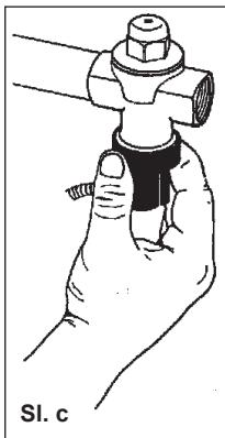
Instalacija ispusnog ventila za termičku zaštitu na temperaturni sigurnosni ventil na topotni izmjenjivač.
