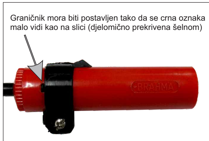
Slika 2. Pažljivo postavite fotoćeliju u nosač na kutijici do graničnika
