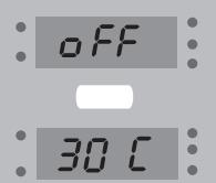
Dobava peleta će se odmah prekinuti, ali će kotao raditi tako dugo dok se akumulirana energija ne potroši. Peć će se automatski isključiti za cca. 30 minuta.
