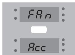
Gornji ekran će prikazati "FAN" dok će donji ekran prikazati "ACC". U ovoj fazi rada kotao provjerava ventilator dimovodnog sustava (traje oko 20 sekundi).
