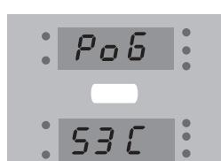
Nakon ove faze, na gornjem ekranu, naizmjenično će se prikazivati snaga kotla (npr. "Pob") i temperatura sobe (npr. "25°C") dok će se na donjem ekranu prikazati temperatura zagrijane vode (npr. "53°C").
