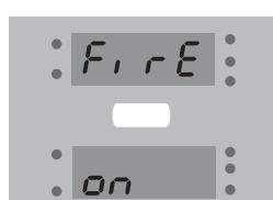
Kada je temperatura dima 50°C (cca. 10 min), kotao će potvrditi paljenje. Na ekranima će se prikazati "FIRE" "ON".
