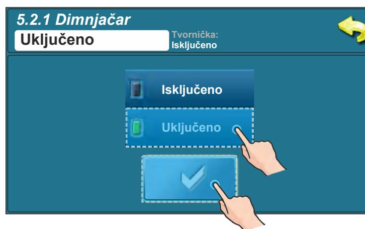
Uključenjem ove opcije tipka "PRIKAZ RADA" postaje tipka DIMNJAČAR (1) i pritiskom na nju, direktno ulazimo u izbornik DIMNJAČAR (bez potrebe za listanjem po izbornicima). U tom izborniku imamo pristup i mogućnost izmjene parametara izbornika DIMNJAČAR.
