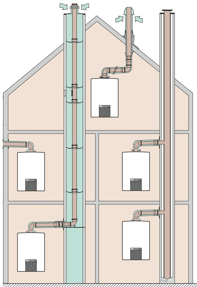
Mogućnosti izvođenja zrako-/dimovodnih sustava
