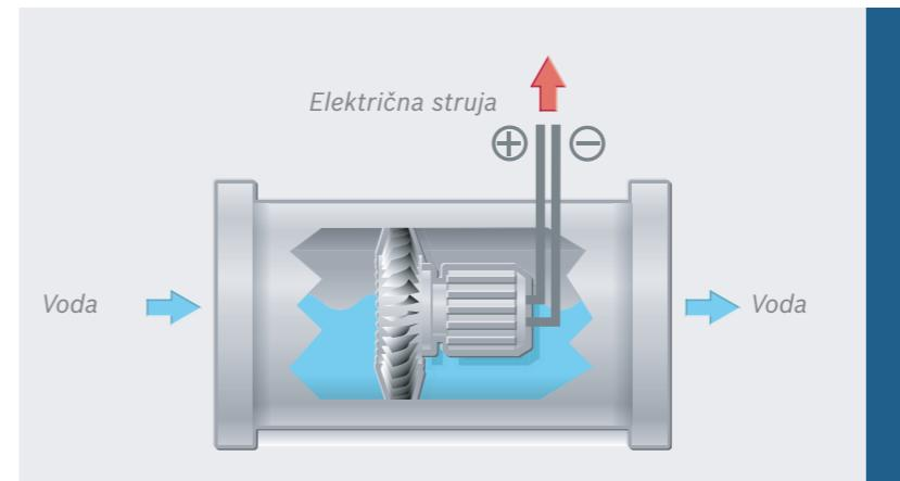
Rad hidrodinamičnog paljenja temelji se na jednostavnom načelu: krug vode u uređaju sadrži hidrodinamični generator. Voda u protoku ga pokreće, te generator proizvodi energiju za paljenje plamenika. Ovom metodom ostvaruje se ušteda na potrošnji plina od 25%.
